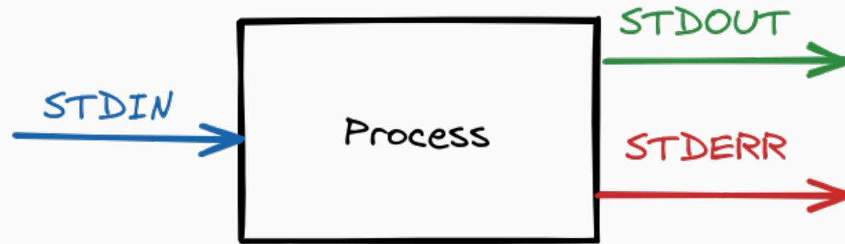
Fig. 1. – Schématisation des entrée/sorties d'un processus
